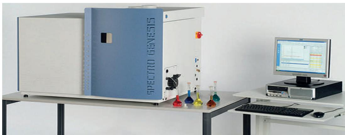
Рисунок 1. ICP-спектрометр (с возбуждением спектра в индуктивно-связанной плазме)
