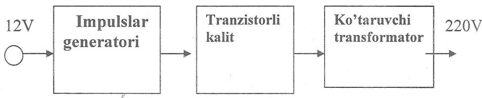
1-rasm. Invertor qurilmasining blok sxemasi.
