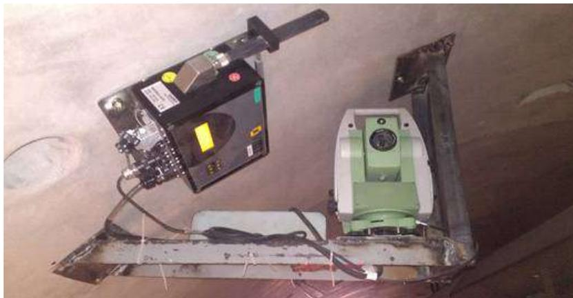
3-rasm:Yarim robotlashtirilgan lazerli taheometr va siljuvchi radiomodem.
